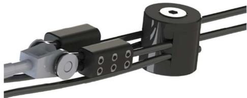
Il s'agit d'un connecteur non orientable permettant de repiquer la tension 24VDC en provenance du transformateur sur les fils caténaux en Kevlar. Ce dernier s'installe sur le caténaire à l'endroit où vous souhaitez faire arriver le 24VDC, le câble en provenance du transformateur devant avoir un diamètre extérieur maximal de 3,2mm avec une section de 1,5mm<sup>2</sup> au maximum.
